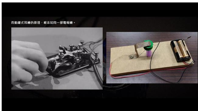
原理實在是非常簡單，只要有一條通電的電線，不斷切換為打開和閉合電路，發訊號的一端，就能發出摩斯密碼，傳輸到接收訊號的遠方。而接收訊號的一方，則要把銅線繞在一支固定的鐵釘上，形成一個線圈，當有電流通過線圈，就會產生磁極，令鐵釘上方的鐵片，被磁力吸引而打在鐵釘上。
