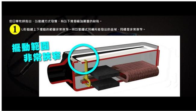
二、由於動鐵式 U 形鐵，是以一秒上下擺動過萬次，震動上面的震膜發出聲音，所以這兩個位置，會因震動過多，短時間內就產生金屬疲勞而斷裂，即圖中，U 形彎位的橫桿位置及推動震膜的小驅動棒，並小驅動棒和 U 形鐵與震膜連接的地方。
