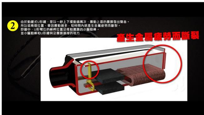
所以大家在這裡就可以清楚看見，對比動圈式和動鐵式在物理上會損壞的地方，動圈式損壞較少，也耐用很多。因為，動圈式只有最大面積的震膜紙盆和包圍紙盆的橡膠折環，才會因上下震動太多而損壞，所以，至少使用數萬小時以上，才會因勞損而破裂。
